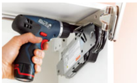
Za pomocą wkrętarki (Pozidriv®, wielkość 2, długość 39 mm), ustawia się siłownik odpowiednio do wagi frontu. Pomaga w tym skala.
